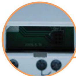
→ Разъем для подключения дополнительного модуля памяти и кабеля соединения связи RS-485 с ПК
