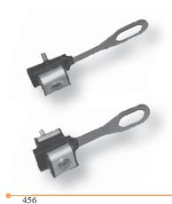
Применение - Концевые держатели применяются в системах изолированных самонесущих проводников. Применяются для крепления СИП ASXSn на стенах строений и столбах с помощью стандартных крюков. Подвесные держатели служат для поддержания пролетов СИП ASXSn сечением 16 - 120 мм² стандартными шурупами с крюком. Угловые подвесные зажимы применяются для подвешивания провода СИП ASXSn под углом 90°.
